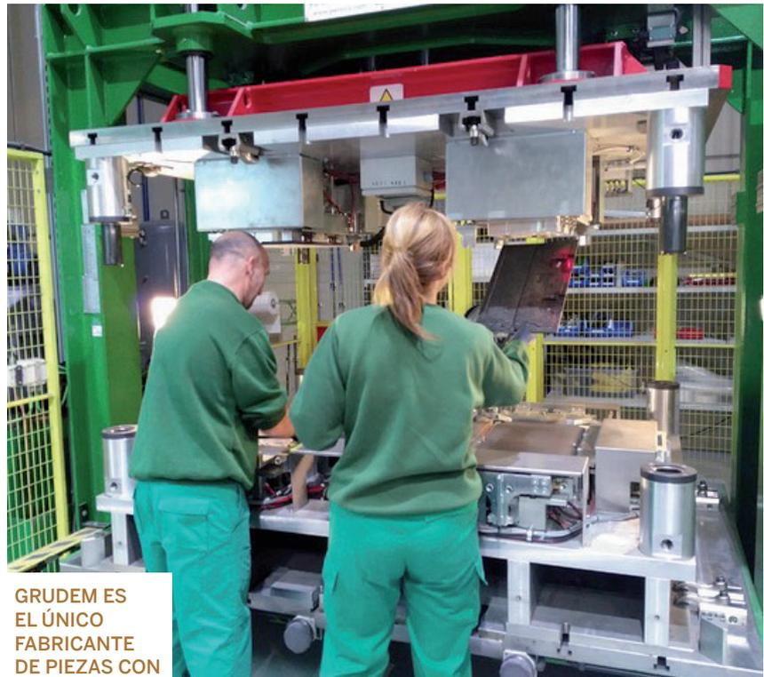
**GRUDEM ES EL ÚNICO FABRICANTE DE PIEZAS CON TECNOLOGÍA NIDO DE ABEJA Y ESPUMA DE POLIURETANO (PU) en el Sur de Europa y produce piezas moldeadas en este material para diversos sectores industriales. Estas piezas están hechas con una espuma rígida de PU, con un núcleo interno basado en un "sándwich" formado por nido de abeja de papel cubierto con capas de refuerzo de fibra de vidrio.**
